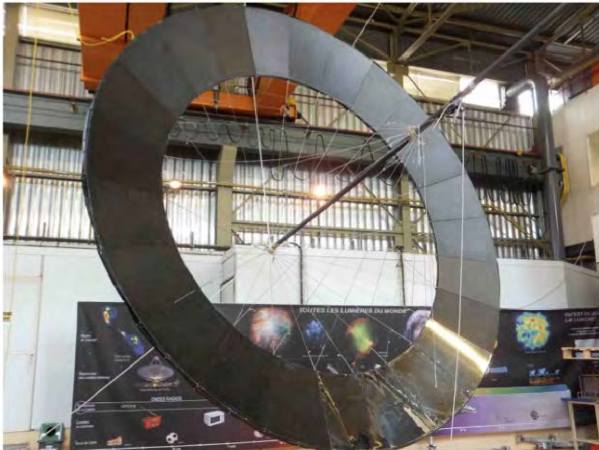
FIGURE 5.7 – Modèle réduit du télescope déployable TALC dont le concept a été proposé au séminaire de prospective scientifique du CNES en 2014.
