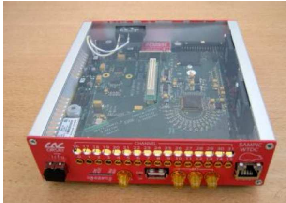
FIG. 214 – Photographie du boîtier complet intégrant la puce SAMPIC, qui est le composant rectangulaire noir situé sur la face supérieure bien visible sur la photographie. Le boîtier inclut une ou deux cartes files (ici une seule, correspondant à la carte placée sur le dessus) et une carte mère (carte du dessous) permettant le contrôle général du système ainsi que la lecture des données en sortie.
