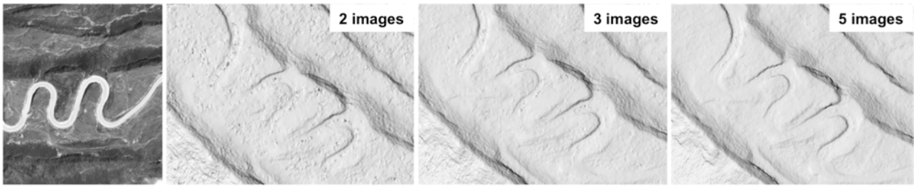
Figure 55 – Effet du nombre d’images sur le bruit du modèle numérique de terrain métrique généré à partir d’images Pléiades sur le rift d’Asal-Ghoubbet.
