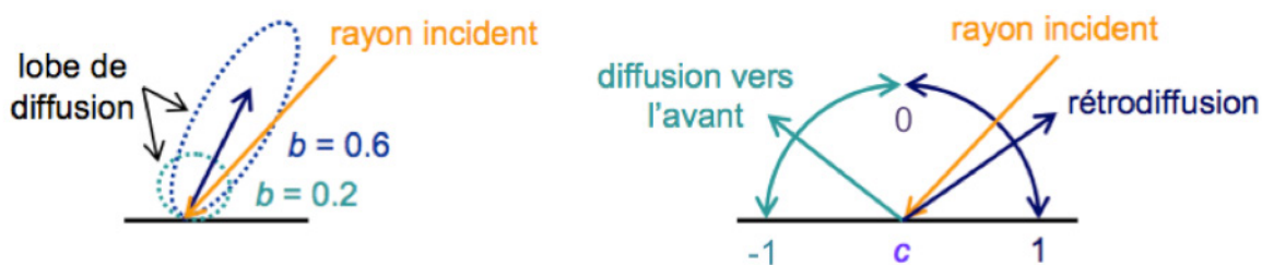
Figure 16 - Effet des paramètres de la fonction de phase b et c sur la forme du lobe de diffusion (d'après Souchon, 2012 ).
