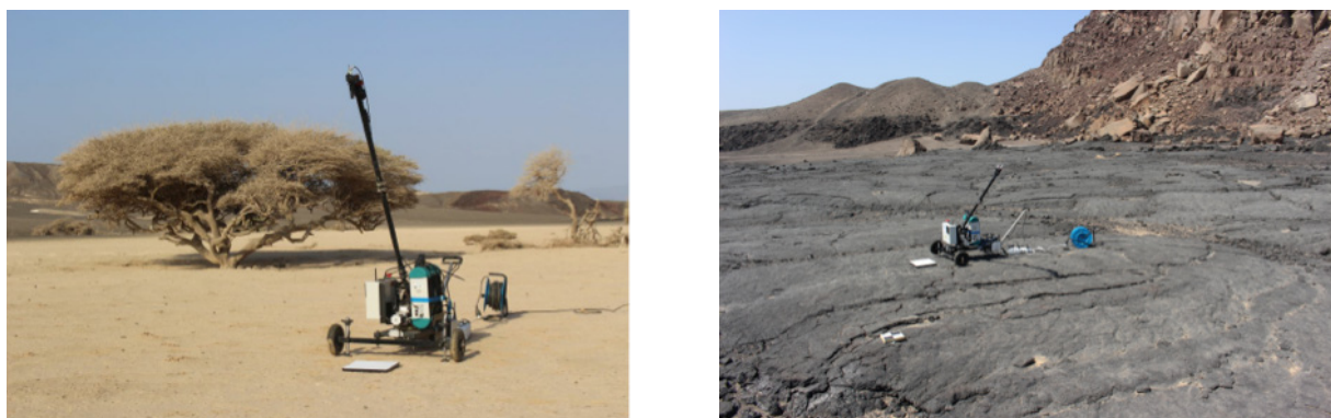
Figure 78 – Illustration du spectrogoniomètre de terrain Chamelon (ONERA-DOTA, Toulouse) en action sur les sites F (gauche) et M (droite).
