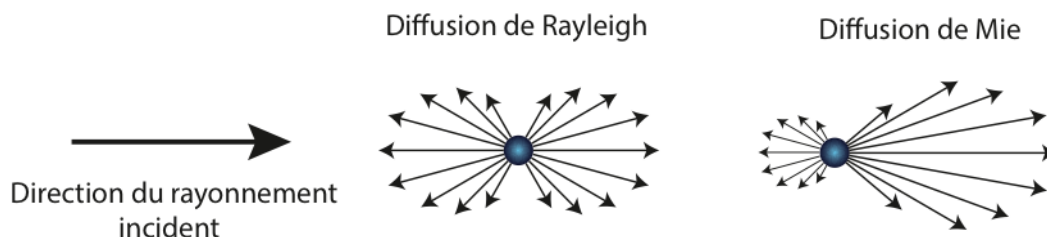
Figure 58 – Phénomène de diffusion par les molécules gazeuses et les aérosols atmosphériques.
