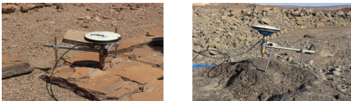
Figure 54 – Points de contrôle mesurés par GPS pour contraindre l'orientation du MNT Pléiades.
