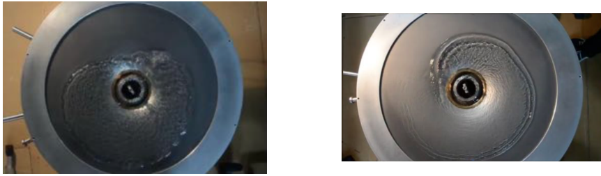
FIGURE 2.8 – Mode spiral de l’instabilité SWASI (gauche) et \text{low-T}/|W| (droite) observé expérimentalement. Extrait de Foglizzo et al. (in prep).
