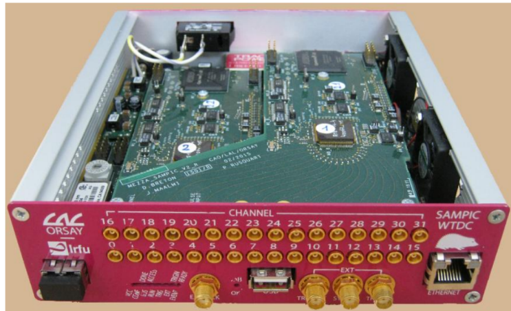
FIGURE 2.32 Photographie du boîtier complet intégrant les deux puces SAMPIC, qui est le composant rectangulaire noir situé sur la face supérieure bien visible sur la photographie. Le boîtier inclut une carte fille (correspondant à la carte placée sur le dessus) et une carte mère (carte du dessous) permettant le contrôle général du système ainsi que la lecture des données en sortie.
