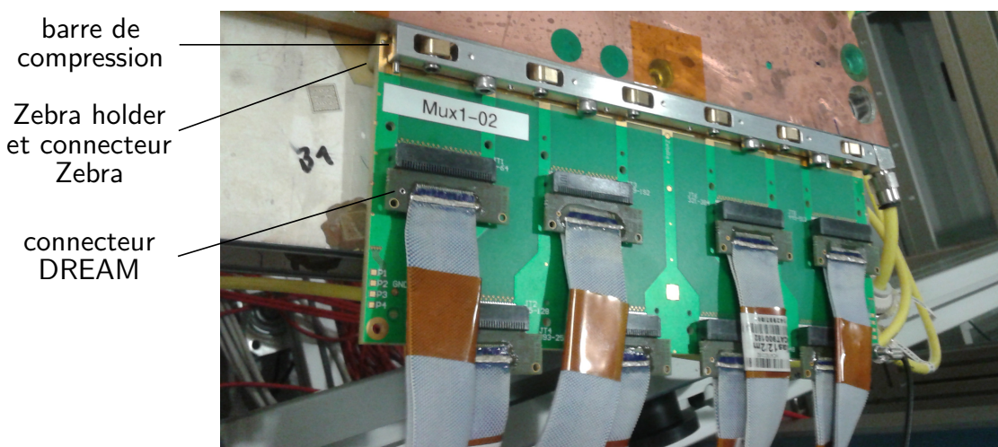
Figure 3.8 – Photo d’une carte d’adaptation avec ses huit connecteurs. Ceux-ci sont reliés à une carte DREAM non représentée sur l’image. Une barre de compression est visible. Elle comprime un connecteur Zebra contre le détecteur, afin d’assurer la liaison électrique entre les canaux de la carte et les pistes du module. Une pièce mécanique appelée « Zebra holder » sur le schéma contient le connecteur Zebra.
