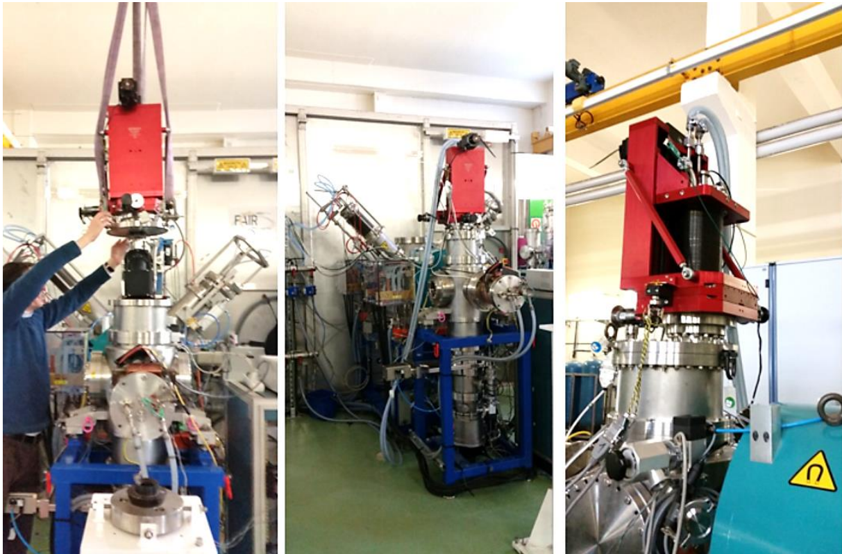
Figure 76 : Photographies d'installation de l'EMIT4D pour les tests sur l'injecteur de FAIR
