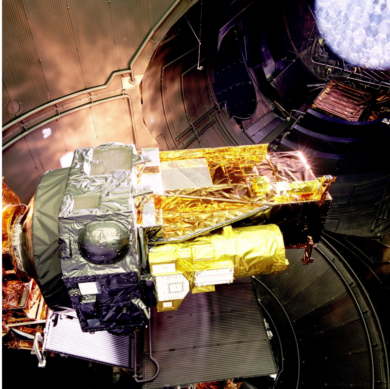
Figure 1.16 – Modèle de vol du satellite INTEGRAL (ESA) lors d’essais thermique dans une gigantesque chambre à vide située à l’ESTEC à Noordwijk, aux Pays-Bas.
