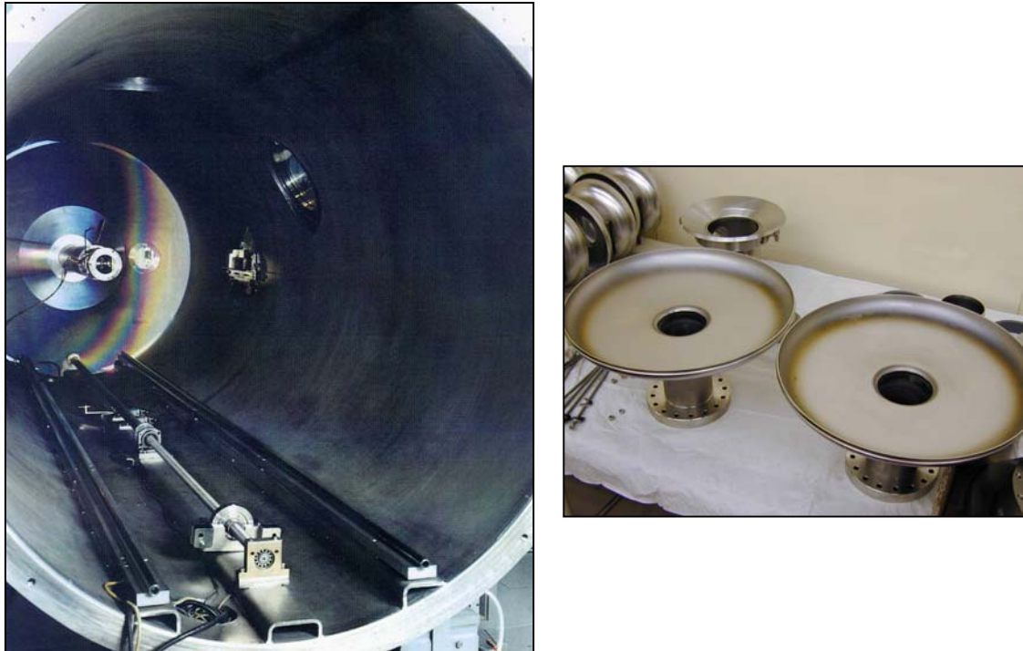
Figures 4-2 : Vue du tank ( \varnothing=1,5m , L=4,5m ) dans lequel s'effectue le soudage FE (source : CERCA), et vue interne des demi-cellules de la cavité Z101 après soudage des iris.
