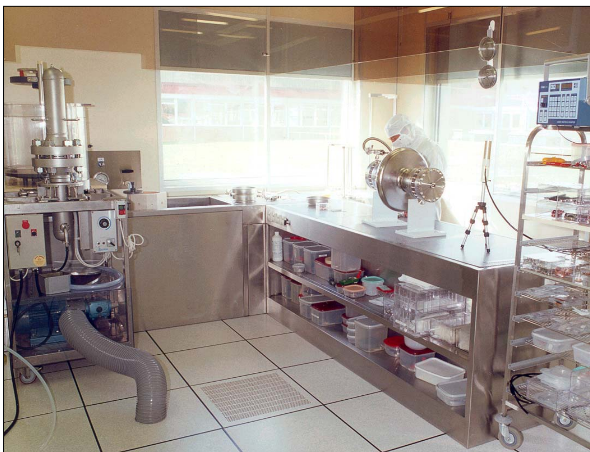
Figure 4-7 : Assemblage final de la cavité A104 en salle blanche classe 100 (à gauche : le dispositif HPR).
