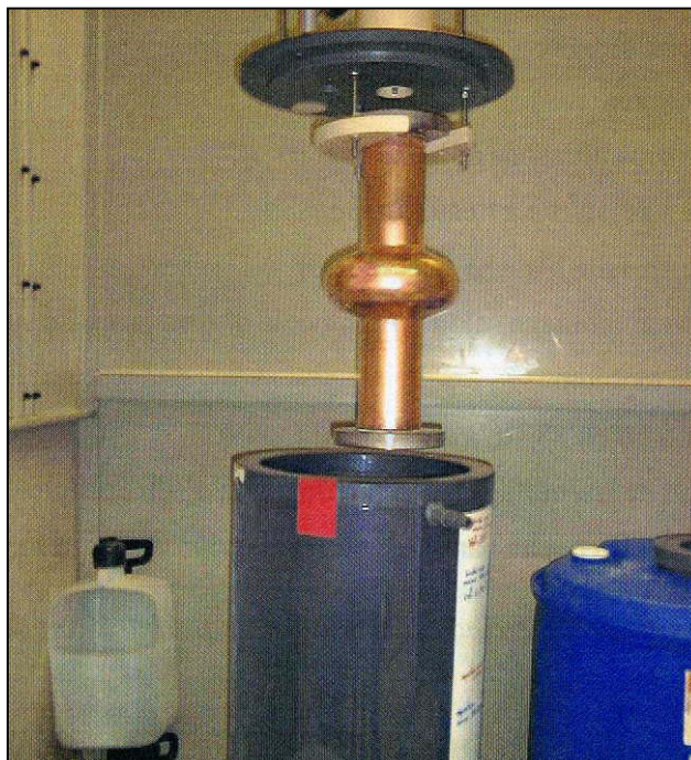
Figure 4-6 : Polissage chimique d'une cavité 1,5GHz \beta_g=1 en cuivre.
