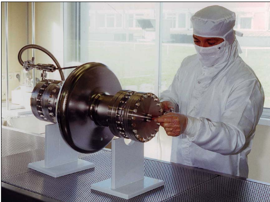
Figure 4-39 : Mise en place en salle blanche des rallonges sur A104.
