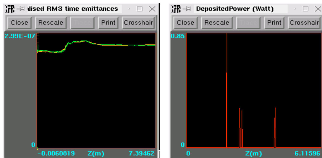
FIG. 6.13 – Variation des deux émittances transverses et dépôt de puissance en watt le long du RFQ. Aucune particule n'est perdue avec une énergie supérieure à 2 MeV, seuil d'activation du cuivre.
