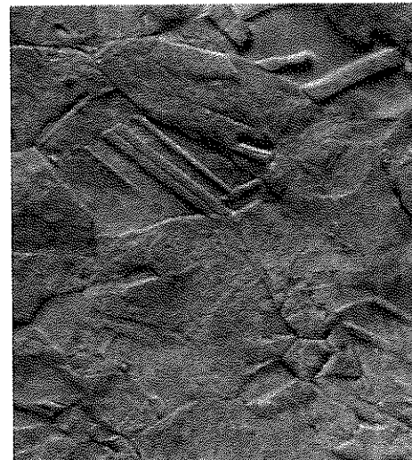
e) et f) Micrographies du cuivre après attaque chimique (bain SN2)
