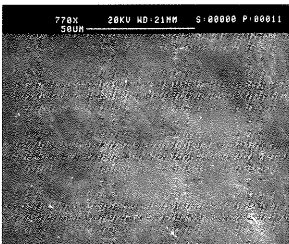
c) Interface et Surface de l'échantillon Nb/Cu SN2 ( R_a=0,025\mu\text{m} )
