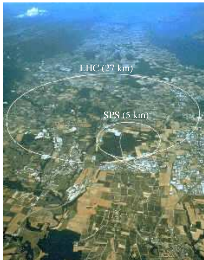
Figure 4: Matérialisation des accélérateurs du CERN. Le cercle de plus grand diamètre représente le LHC (Large Hadron Collider), le plus petit matérialise le SPS (Super Proton Synchrotron).
