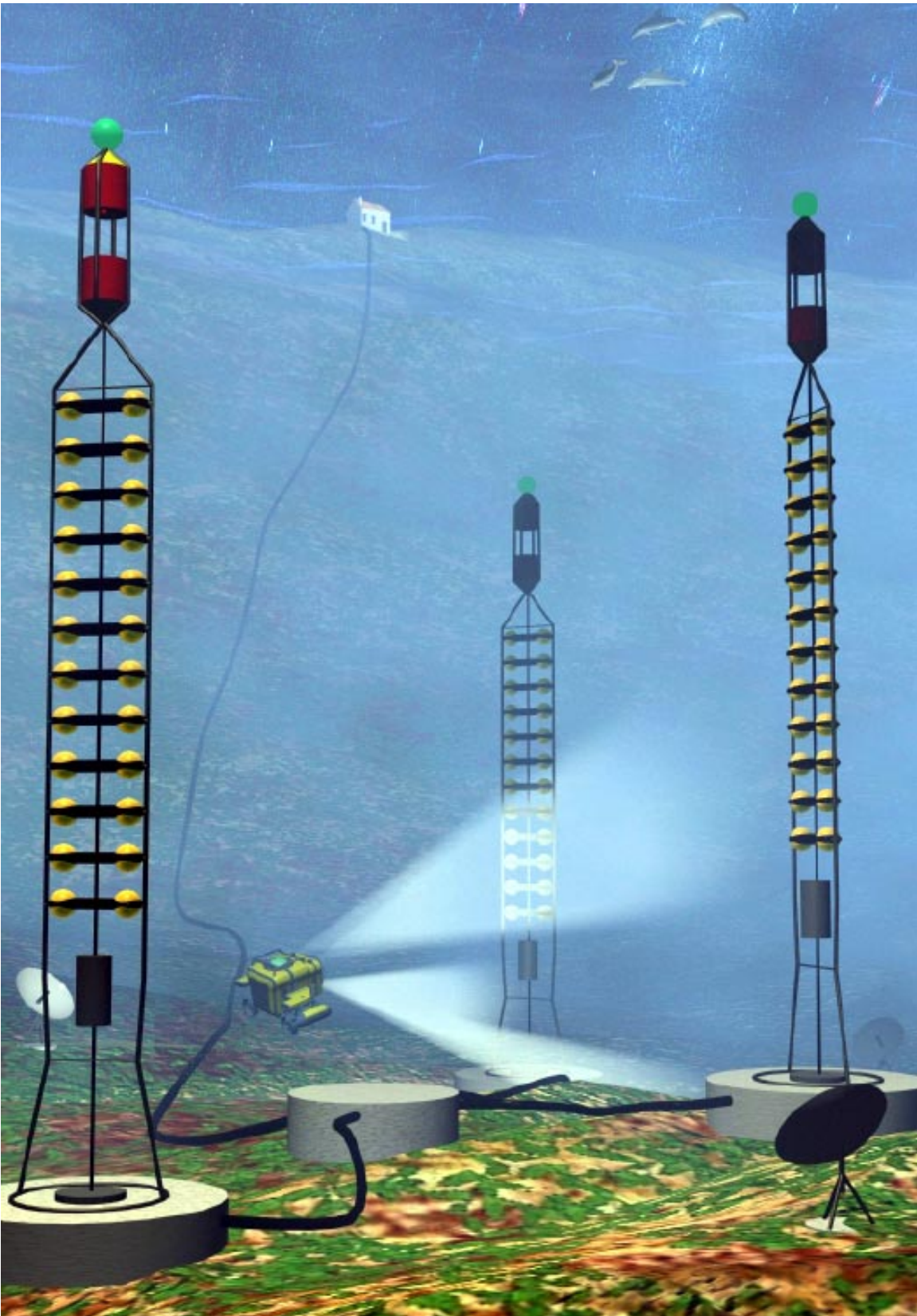
FIG. III.1 – Une vue d'artiste du télescope à neutrinos envisagé par ANTARES : des lignes équipées de photomultiplicateurs sont immergées par 2300 m de fond, et reliées à la côte par un câble électro-optique. Un sous-marin assure la connexion des différentes lignes à ce câble. Chaque détecteur mesure typiquement 400 m de hauteur pour 1m60 de large, et 100 m séparent les lignes entre elles.
