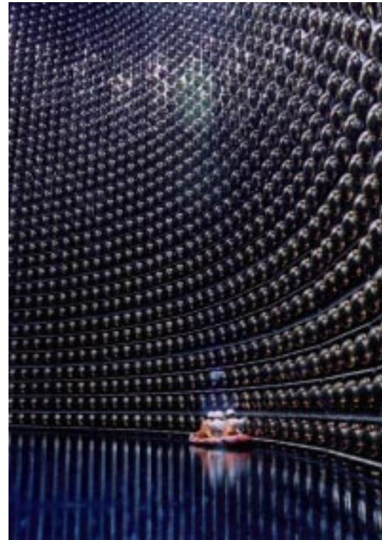
FIG. I.4 – L'expérience SuperKamioKande : en haut, une représentation générale du détecteur. Il mesure 41,4 m de hauteur pour 39,3 m de diamètre et contient 50 000 tonnes d'eau pure. Sa surface interne est tapissée de 11200 photomultiplicateurs de 50 cm de diamètre. En bas à gauche : un ouvrier travaillant à l'installation de la paroi supérieure du détecteur. A droite : des ouvriers nettoient la surface des photomultiplicateurs pendant le remplissage du réservoir.
