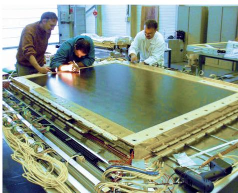
Construction, à l'Irfu, des chambres à dérive pour l'expérience Compass. Ces détecteurs de très grande dimension permettent de tenir le flux de 1 MHz par fil et ont une résolution en position de 150 microns.
