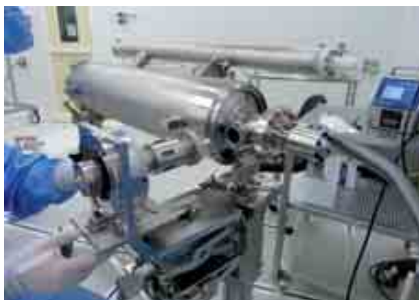
Les coupleurs de puissance permettant de transmettre la puissance à la cavité et au faisceau sont composés de deux parties ; la partie fonctionnant à température cryogénique (manipulée par l'opérateur) est assemblée dans la salle blanche (ISO4).
