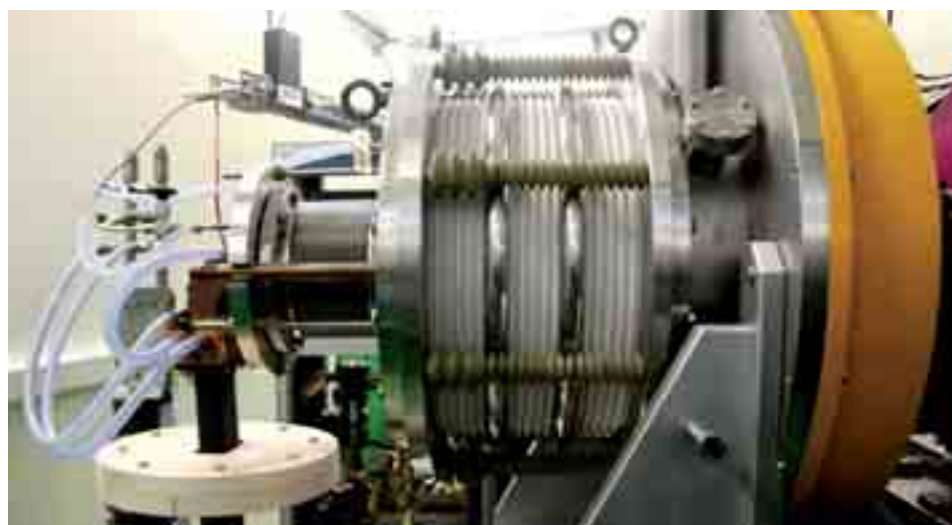
Source Alises, mise en place sur le banc de tests Betsi.
