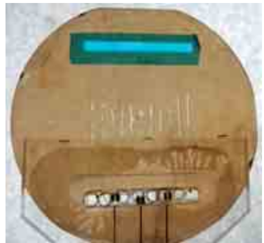
Microcanaux (2 mm x 10 \mu\text{m} ) creusés dans un substrat de Pyrex. En bas : réservoir d'hélium équipé d'un chauffeur (fil en tire-bouchon) et de capteurs de température miniatures. En haut (couleur verte) : sortie des canaux dans le bain d'hélium superfluide.
