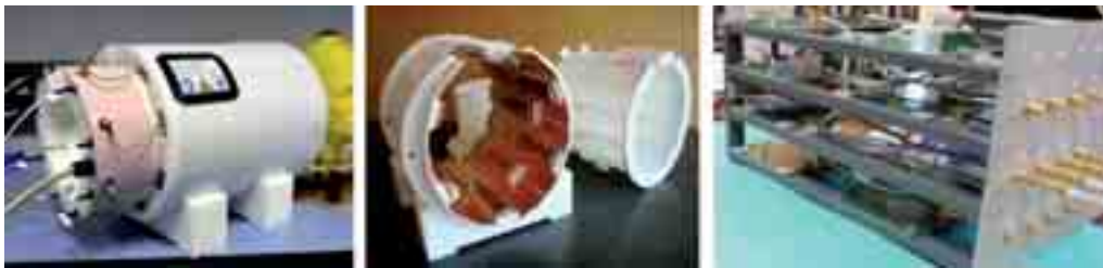
Antennes à 7 T développées par le SACM. De gauche à droite : antenne à 8 voies, à 12 voies et son interface SVD (singular value decomposition).
