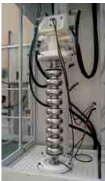
Cavité pour l'ILC ( International linear collider ) installée sur le banc d'électropolissage vertical avant traitement.
