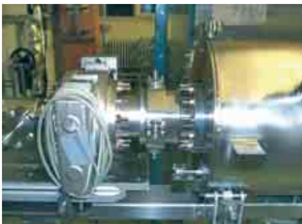
BPM ré-entrant monté dans un cryomodule prototype de XFel.
