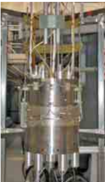
Prototype R1 : empilement de 6 galettes prototypes, de rayon intérieur de 185 mm et de rayon extérieur de 240 mm, dans une structure mécanique pour étudier les caractéristiques mécaniques du conducteur Iseult sous un champ magnétique intense (12 T).
