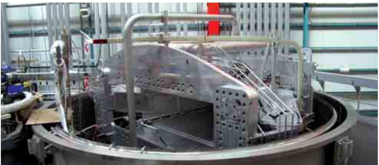
Masse froide déposée dans un des cryostats de la station d'essai W7-X de Saclay pour son test de réception au courant nominal.
