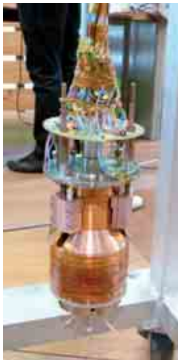
Double galette d'YBaCuO instrumentée prête à être assemblée sur la canne de test sous champ magnétique.
