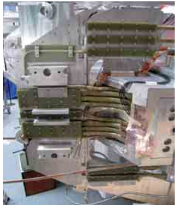
La moitié des jonctions stabilisées, brasées, isolées puis installées sur leur plaque de refroidissement.
