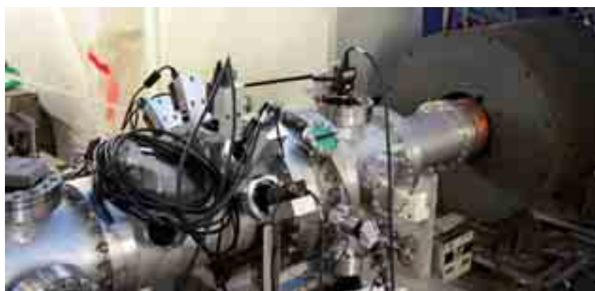
Mesureur de profil par tomographie sur la ligne de transport de Silhi.
