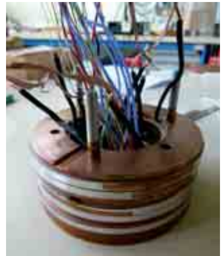
Double galette d'YBaCuO instrumentée prête à être assemblée sur la canne de test sous champ magnétique.
