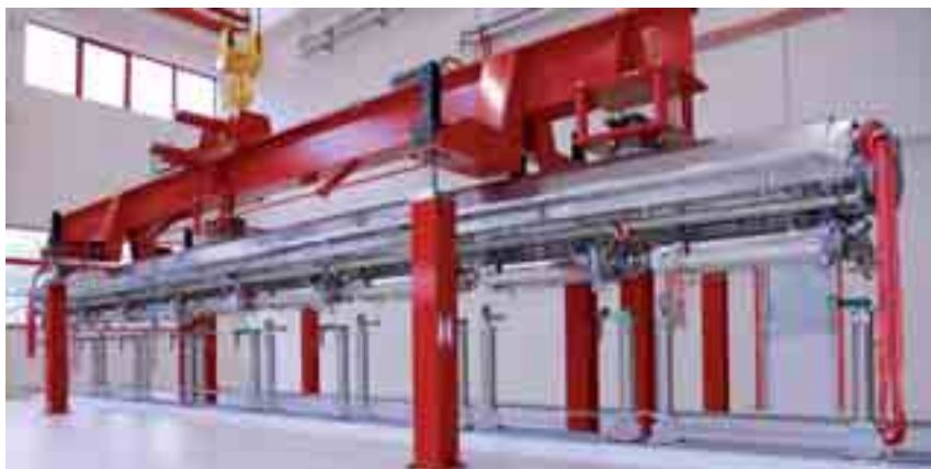
Le train de cavités équipées de superisolant, du blindage magnétique et du système d'accord de fréquence est suspendu à la distribution cryogénique. L'ensemble est transporté de poste en poste par des portiques (en rouge).
