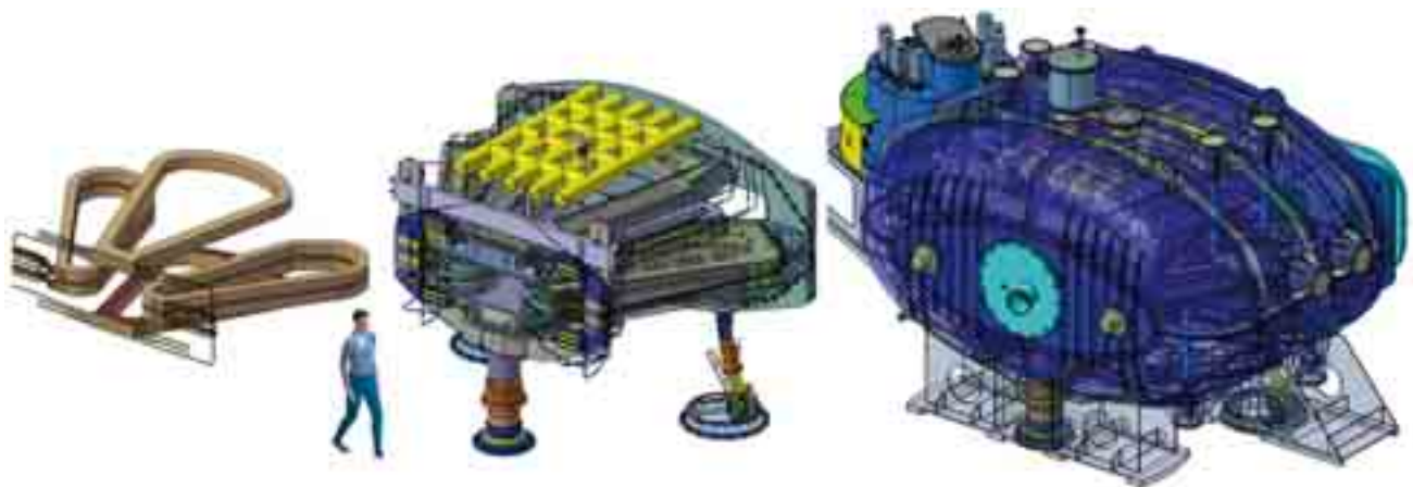
À gauche : la structure magnétique composée de 6 bobines trapézoïdales. Au milieu : la masse froide de l'aimant comprenant les quatre boîtes à bobines ainsi que les plaques de liaison et leurs supports cryogéniques. Les boîtiers de jonction électrique entre les câbles supraconducteurs sont visibles ici sur fond bleu. En jaune figure le réservoir de 460 l alimentant les tubes de refroidissement indirect à 4,5 K par circuit thermosiphon. À droite : le cryostat flanqué de son satellite cryogénique regroupant les connections externes ; il se déplacera sur coussins d'air. La masse totale de l'aimant est de 55 tonnes.
