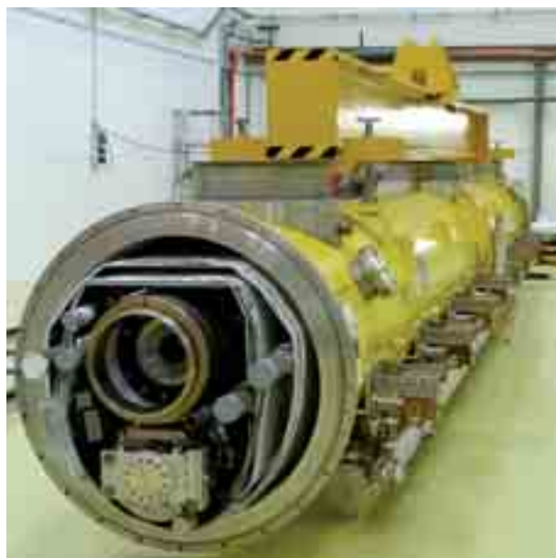
Le cryomodule est équipé de tous ses composants ; la ligne de pompage des coupleurs est en cours de pompage.
