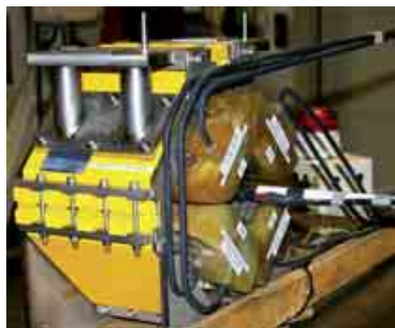
Quadripôle de la ligne de transfert à haute énergie (crédit Sigmaphi).
