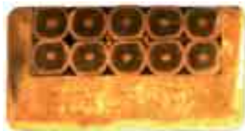
Câble supraconducteur en goulotte pour la bobine principale (9,2 mm x 4,9 mm) comportant 10 brins de fil composite NbTi-Cu insérés dans une goulotte en cuivre puis enrobés de soudure.
