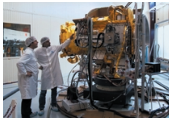
Long de 2,38 m et pesant 1300 kg, le spectromètre SPI est monté sur son dispositif d'étalonnage installé à Bruyères-le-Châtel.
