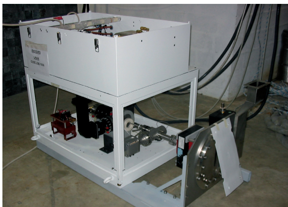
Le linac compact utilisé pour produire le faisceau primaire d'électrons (hauteur de l'ensemble : 1 m).
