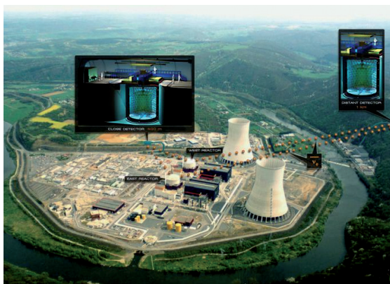
Vue aérienne du site de l'expérience Double Chooz dans les Ardennes. On y voit les deux cœurs de la centrale nucléaire ainsi que les deux détecteurs de neutrinos contenant chacun 250 m 3 d'huile et de liquides scintillants, à 400 m et 1000 m des cœurs.
