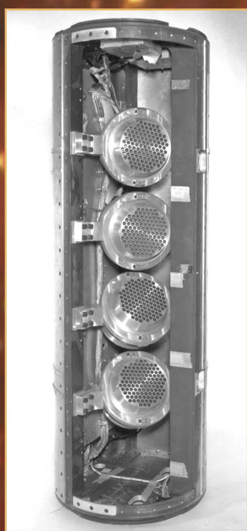
Détecteurs « compteurs proportionnels » construits au CEA pour la détection par fusée des rayons X cosmiques
