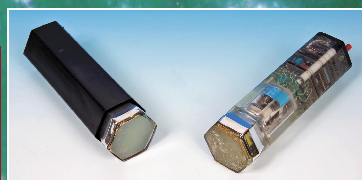
La caméra gamma construite au CEA est un scintillateur en iodure de sodium (NaI), disque de 1.25 cm d'épaisseur et de 57 cm de diamètre, lu par une mosaïque de 61 tubes photo-multiplieurs de forme hexagonale.
