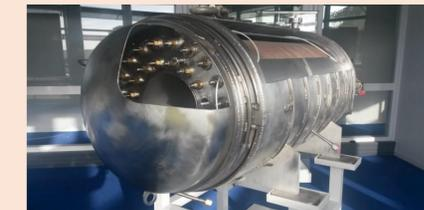
Q0 est une prototype à l'échelle ¼ de la bobine principale de l'aimant Iseult ayant les objectifs suivants :
