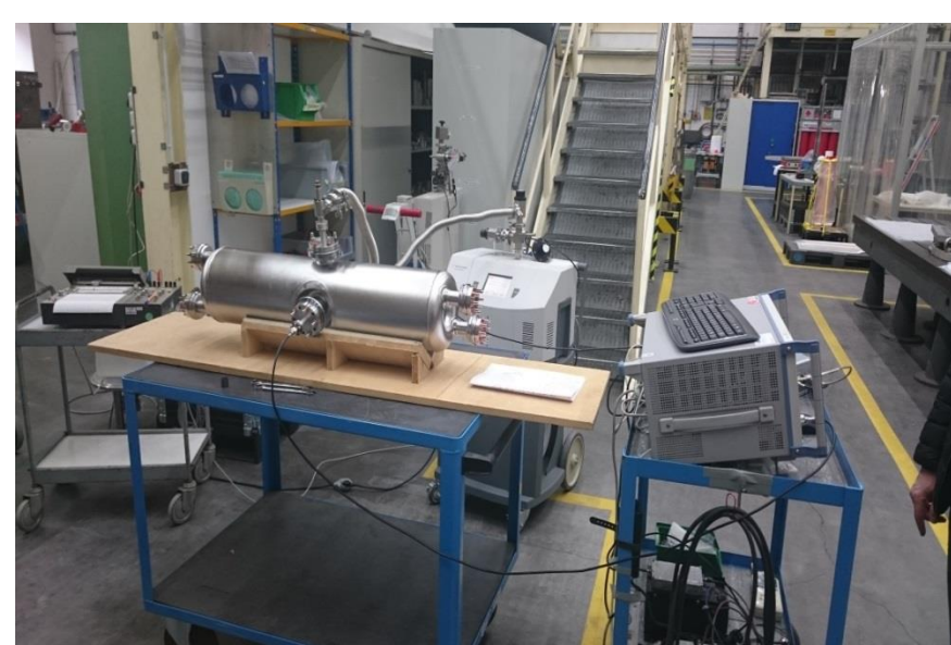
Contrôle RF d'une cavité SARAF
