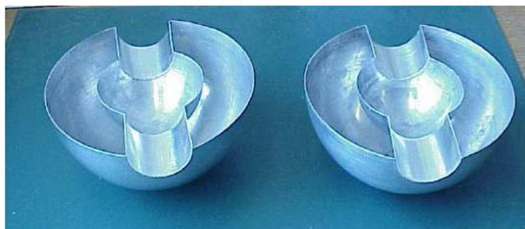
FIG. IV.17 – Les cannings en aluminium de 0,5 mm d'épaisseur forment une coquille sphérique autour de l'échantillon. Après avoir été rempli d'absorbeur, les deux modules ont été fermés par un couvercle plat.
