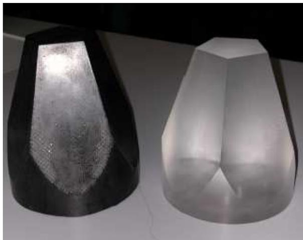
FIG. IV.10 – Prototype des cristaux de BaF<sub>2</sub> pour le détecteur 4 $\pi$  de n\_TOF.
