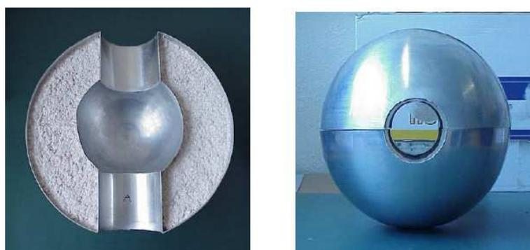
FIG. IV.18 – Gauche : Le canning d'Al ouvert avec le matériel d'absorbeur à l'intérieur. Droite : Les modules combinés d'absorbeur avec la place de tube de faisceau de neutron. Toutes les pièces sont soudées.
