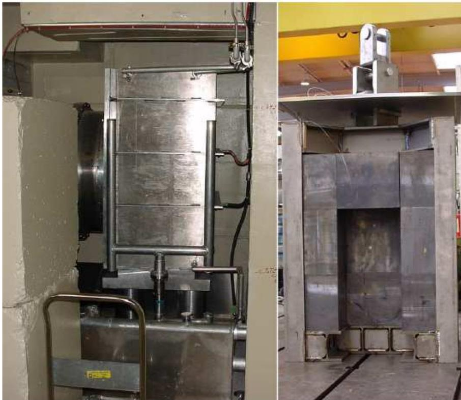
FIG. III.4 – Photo de la cible de spallation avec le système de refroidissement.
