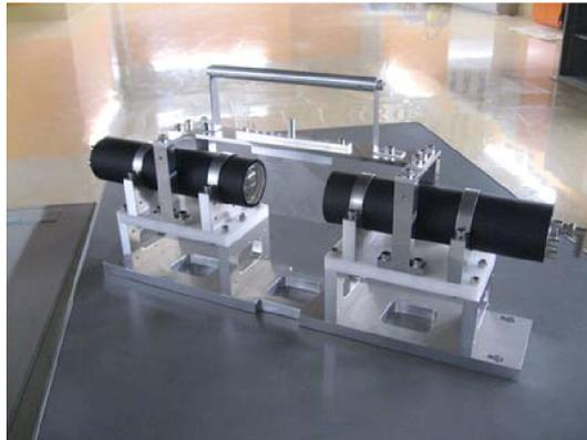
**Figure 2.11** – Vue d'un plastique scintillant utilisé sur la ligne BigRIPS.
