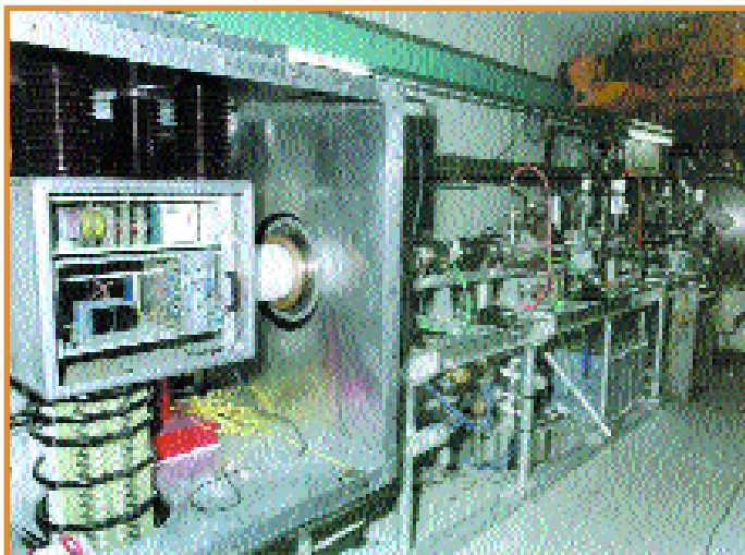
L'injecteur de l'accélérateur supraconducteur MACSE : au premier plan le canon à électrons, puis "l'optique" électronique (qui permet de regrouper et de focaliser les électrons), et au dernier plan une première cavité, dite "de capture", qui communique aux électrons une vitesse proche de la vitesse de la lumière.
