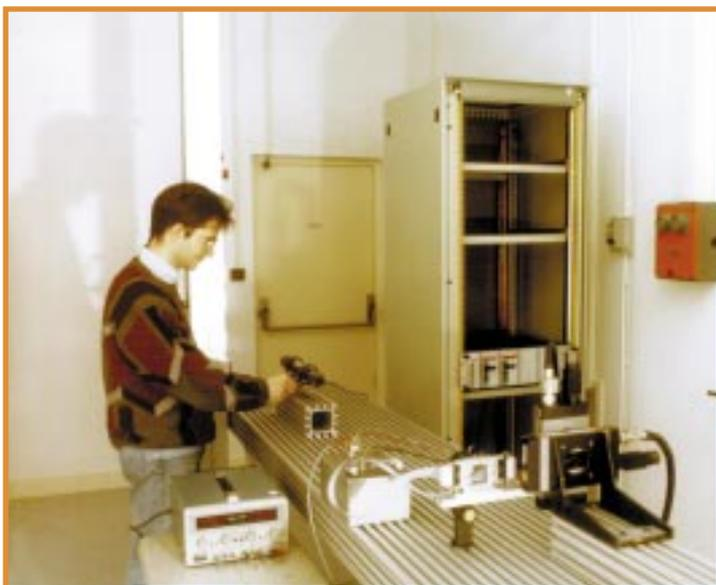
*L'auteur de l'article penché sur son dispositif : le laser, le capteur, deux tables motorisées montées en croix, et la baie d'électronique contenant le module de commande des déplacements.*
