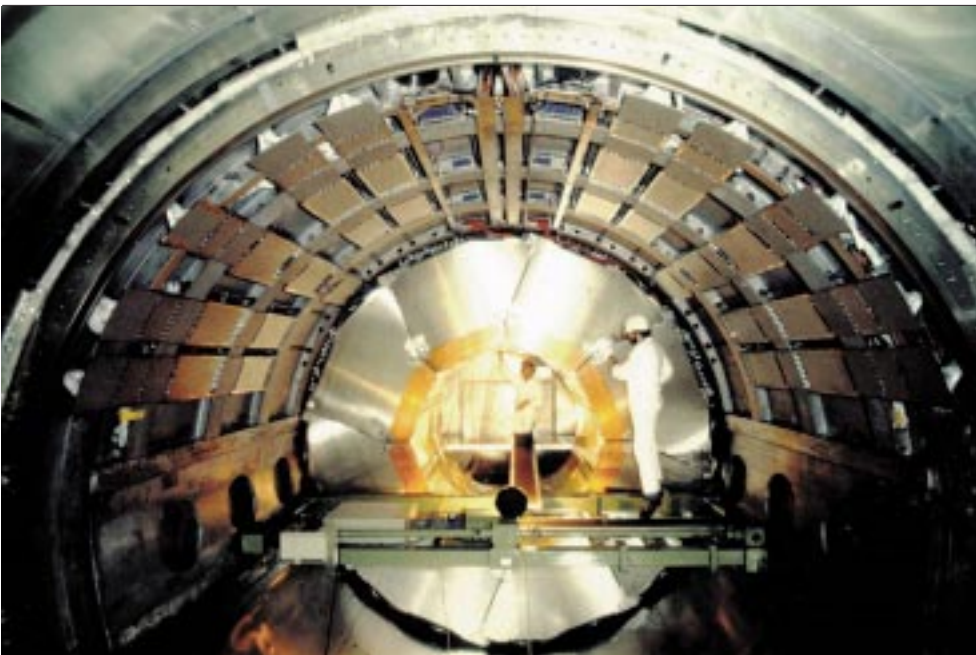
Intérieur du calorimètre à argon de H1 (avant remplissage d'argon liquide)
