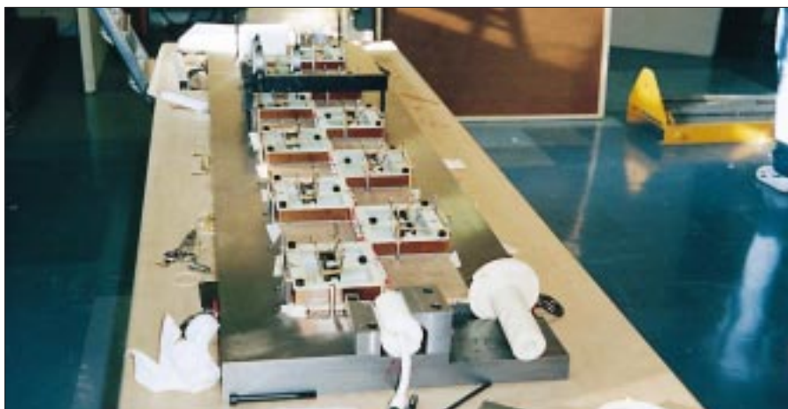
Petite sonde destinée au quadripôle QI, à CEBAF, en phase de construction.
