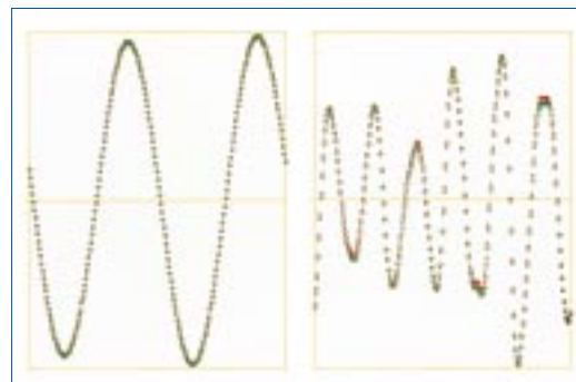
Figure 2 - Signal proportionnel au champ magnétique d'un quadripôle prototype : à gauche le terme quadripolaire, à droite, le terme dodécapolaire dilaté 1000 fois.
