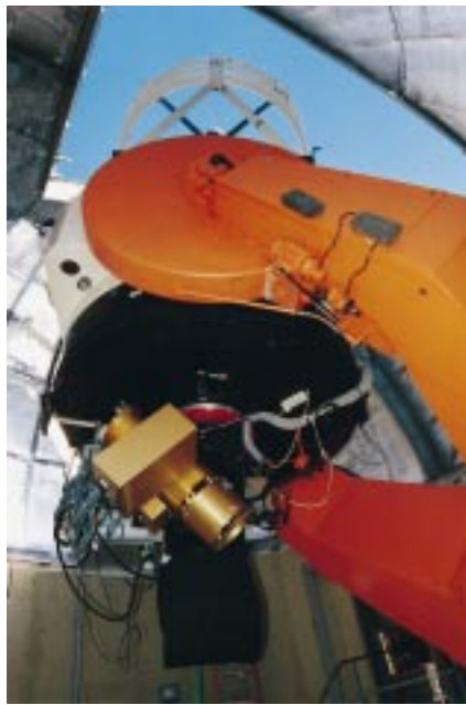
Photo 1 : CAMIRAS montée sur le télescope de 1.5 m TIRGO, situé au Gornergrat en Suisse (altitude: 3100 mètres). La caméra est équipée d'une mosaïque de 192 x 128 détecteurs optimisés pour les observations dans l'infrarouge thermique à partir du sol. Ces détecteurs fabriqués au LETI/LIR du CEN Grenoble sont un sous-produit des développements de détecteurs conduit au LIR dans le cadre du projet ISOCAM. La plupart des observations de la comète ont été faites de jour. Les observations en infrarouge thermique se font aussi bien le jour que la nuit ! En effet, nous ne sommes pas gênés par la lumière du soleil, mais par l'émission thermique de la Terre (dont le maximum se situe dans l'infrarouge thermique) ; cette émission varie très peu entre le jour et la nuit. La sensibilité des observations à partir du sol est drastiquement limitée par ce fond terrestre. C'est pourquoi les observations d'objets faibles doivent être faites à partir d'ob-
