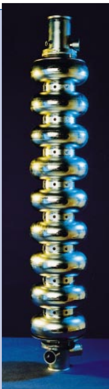
Cavité 9 cellules 1,3 Gigahertz type TESLA
