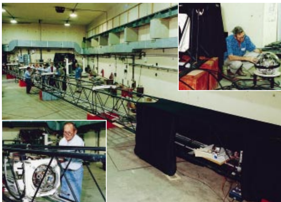
Structure métallique du « démonstrateur ». En incrustations, en haut à droite, un « œil » non monté ; en bas à gauche, un autre « œil » en cours de montage.
