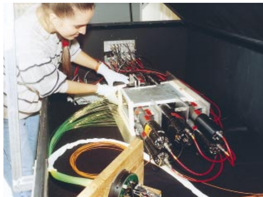
Marie Géléoc (SED), devant le banc de test de cristaux scintillants développés pour l'expérience CMS au LHC.
