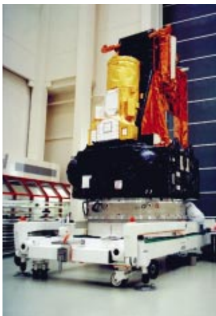
Modèle structurel et thermique du satellite INTEGRAL en cours de montage dans un hall du centre thermique de l'Agence Spatiale Européenne à Noordwijk (Pays-Bas).
