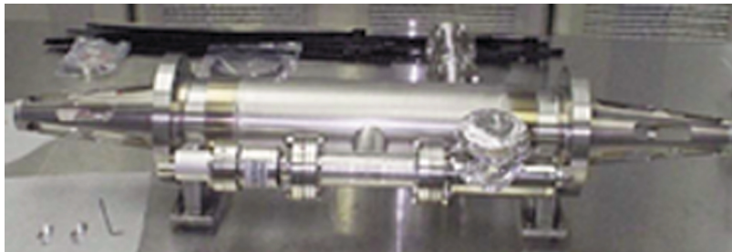
La cavité en salle blanche juste avant le montage des miroirs à chaque extrémité. Les « jours » ménagés dans les deux cônes extrêmes permettent le passage du faisceau d'électrons lors des phases du réglage.
