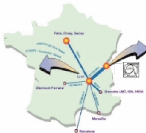
Implantation du DATA GRID en France. Le réseau relie le grand centre français de Lyon à d'autres centres européens, dont le CERN. Les épaisseurs des traits sont proportionnelles aux débits des lignes. La grosse ligne Lyon-CERN véhicule 2,3 gigabits/s.
