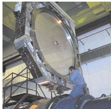
Une des grandes chambres à fils octogonales du NA48, réalisées au DAPNIA
