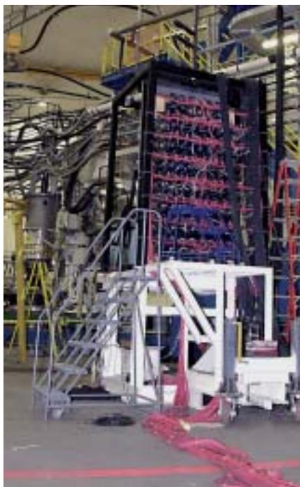
Le calorimètre qui mesure les caractéristiques des électrons diffusés.
