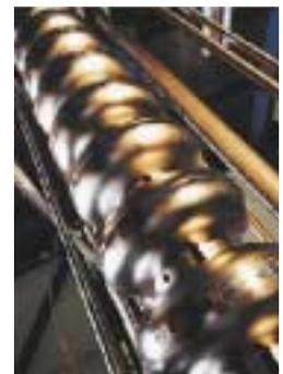
Cavité accélératrice supraconductrice multicellule de type Tesla.
