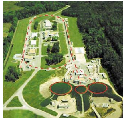
Photo aérienne de Cebaf (Continuous Electron Beam Accelerator Facility), du laboratoire Jefferson (Jlab), en Virginie (États-Unis). L'espèce d'hippodrome en pointillés rouges localise l'accélérateur et les trois cercles rouges signalent les trois halls expérimentaux.
