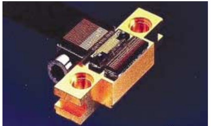
Barrette de dix cellules photovoltaïques en HgCdTe réalisée par le Léli/LIR pour Cirs
