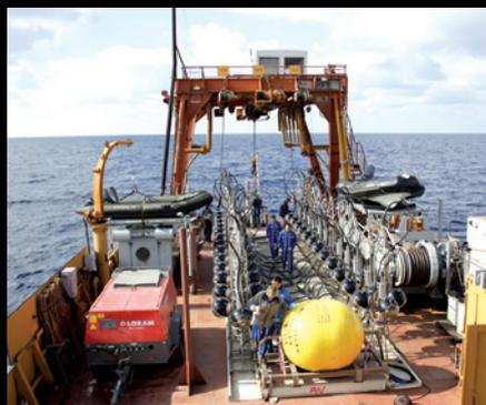
Une ligne sur le pont du Castor, prête à être déployée à 2500 m de profondeur.
