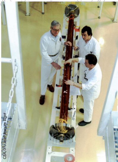
Mise en place de l'isolation sur les quatre pôles du quadripôle.
