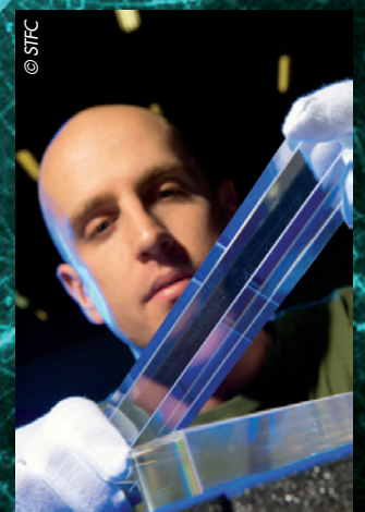
Technicien inspectant un des cristaux de PbWO_4 .
