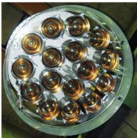
Les photomultiplicateurs de Nucifer regardent la lumière émise lors de l'interaction d'un neutrino avec les protons du liquide scintillant.
