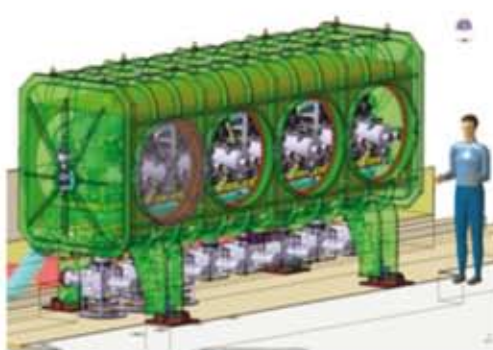
Linac supraconducteur dans son enceinte cryogénique.
