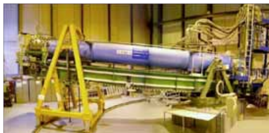
Zone expérimentale de Cast où on voit le dipôle LHC (en bleu) sur la plateforme qui lui permet le mouvement.
