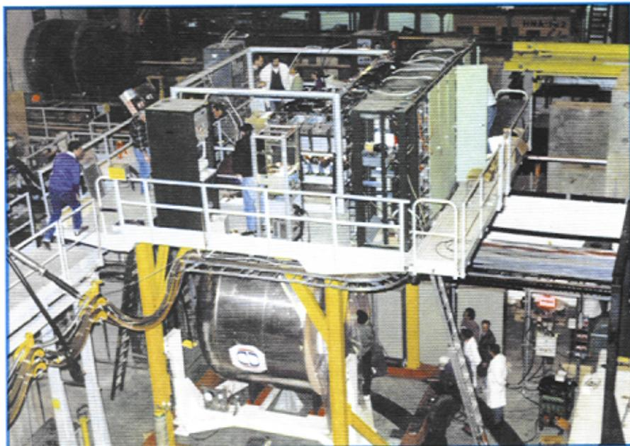
Vue de la zone RD3 sur le faisceau test du CERN Prevoisin : la plateforme est mobile et supporte les 30 tonnes du cryostat et du calorimètre.
