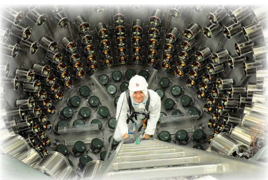
Olivier Corpace, responsable de l'intégration sur site lors du montage des supports d'enceintes en acrylique.
