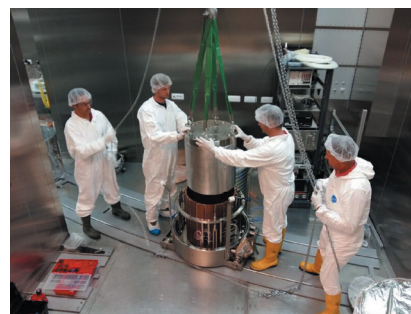
Test d'intégration du blindage factice de CeSOX au Gran Sasso.
