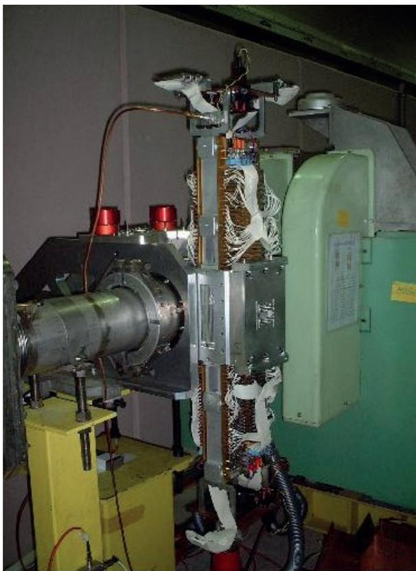
Figure 1. Un des détecteurs de Kabes déplacé horizontalement de 20 cm hors de la ligne du faisceau pour en apercevoir la fenêtre d'entrée.
