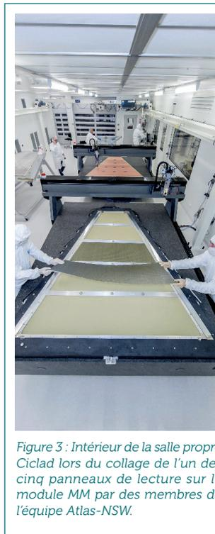
Figure 3 : Intérieur de la salle propre Ciclad lors du collage de l'un des cinq panneaux de lecture sur le module MM par des membres de l'équipe Atlas-NSW.
