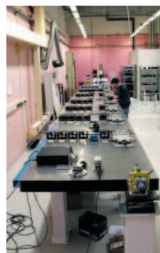
Banc de contrôle des systèmes d'alignement des chambres à muons d'Atlas.
