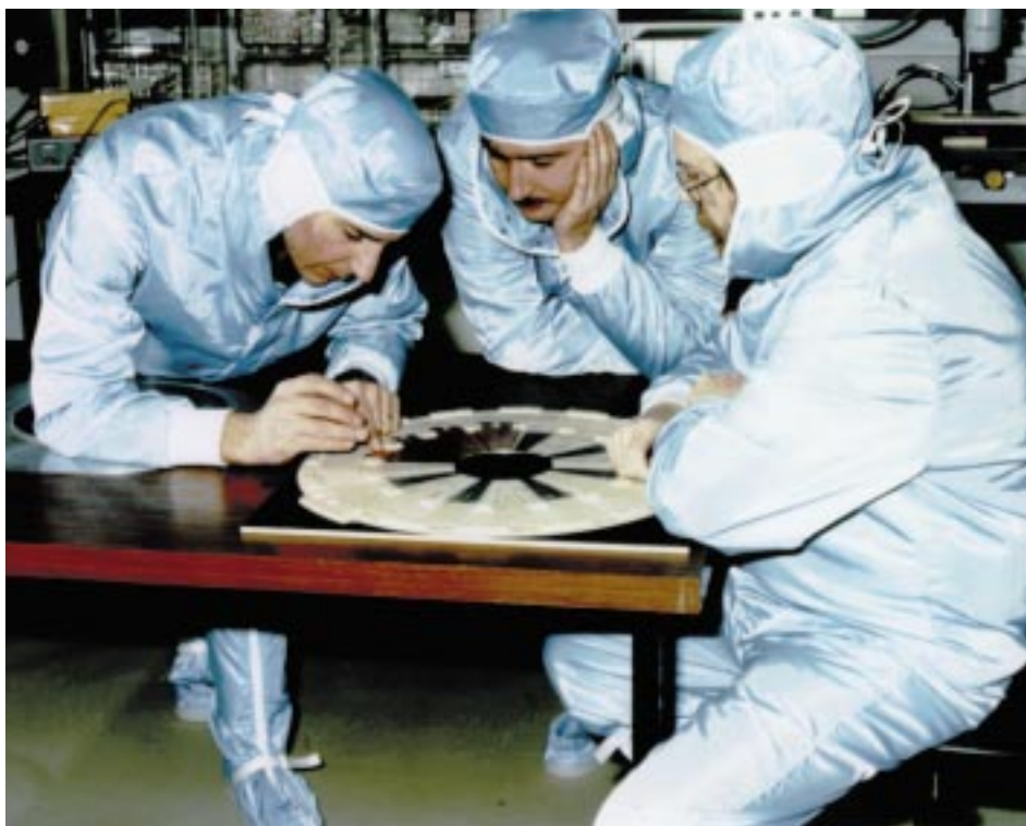
Essai d'assemblage d'un plan du calorimètre de luminosité SiCAL d'ALEPH
