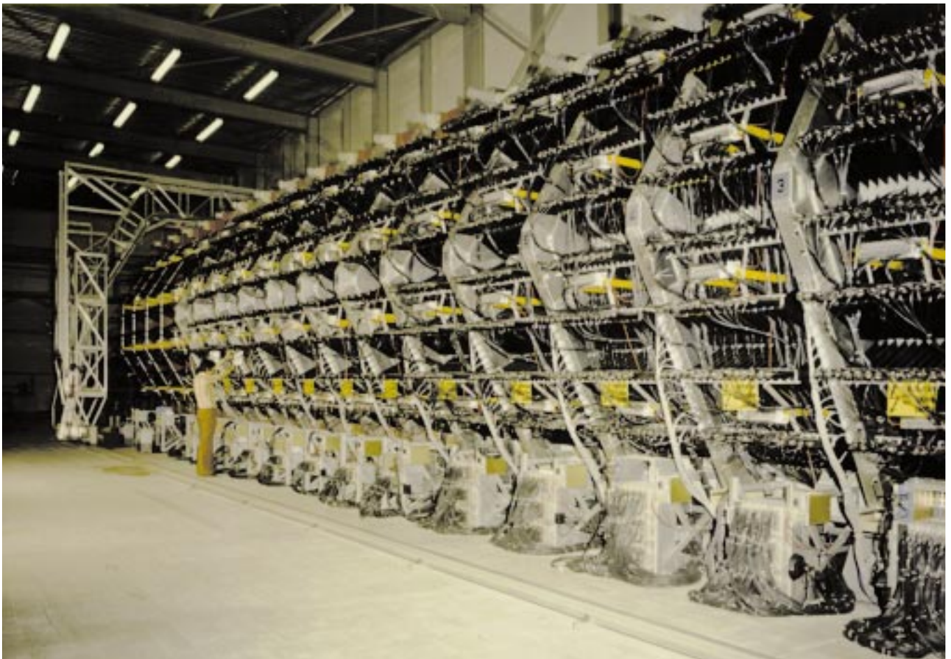
L'expérience CDHS pour l'étude des interactions neutrinos. Les grandes chambres hexagonales construites par Saclay fonctionnent encore dans plusieurs expériences et tests
