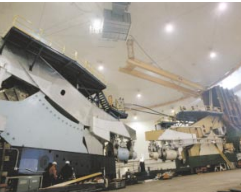
Le spectromètre magnétique à haute résolution "HRS" dans le hall "A" de CEBAF en Virginie (États-Unis). Les quadripôles supraconducteurs de ce spectromètre ont été construits sous contrat par le STCM.
