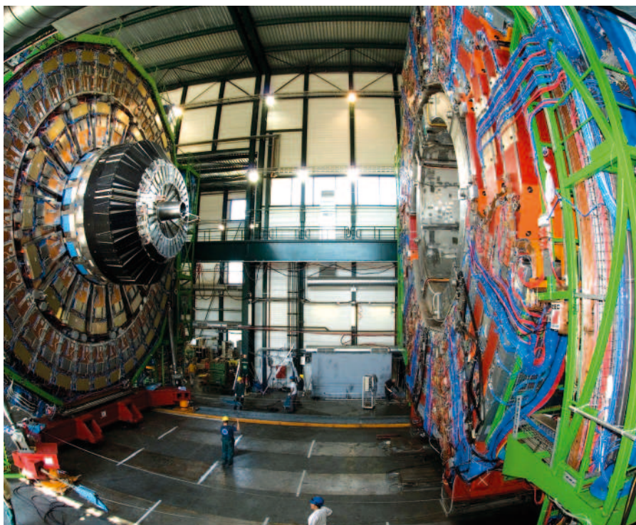
Un peu du détecteur CMS, au LHC, 21 m de long, 16 m de diamètre, 100 000 fois le champ magnétique terrestre dans quelque 500 m 3 , une énergie stockée capable de soulever de deux mètres la Tour Montparnasse. Le Dapnia en est l'un des concepteurs majeurs depuis plus de 10 ans.
