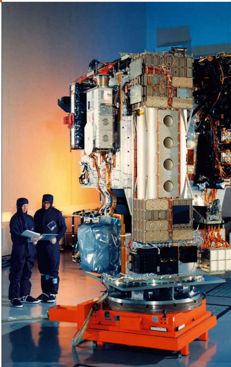
Le satellite SoHo (lors des derniers tests d'intégration) a été lancé par une fusée Atlas-Centaure et scrute le Soleil à 1,5 million de km de la Terre. Ce satellite, lancé en 1995, est toujours en observation avec des instruments qui étudient le Soleil, du cœur à la couronne. L'instrument GOLF est visible à gauche de l'image.
