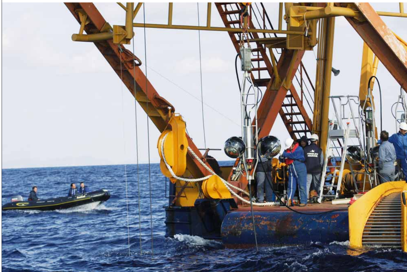
Immersion d'un étage à trois « yeux » lors du déploiement de la première ligne d'Antarès à 40 kilomètres de la Seyne-sur-Mer.
